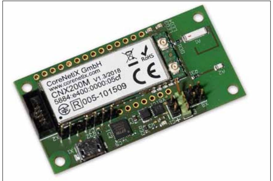
Bild 2. Das IP500-Funkmodul CNX200 enthält einen Mikrocontroller für den IP500-Netzwerk-Stack und auch die Antenne. Es erfüllt alle Anforderungen für die weltweite Zertifizierung – für Europa (RED), Indien, Japan, USA (FCC) etc. (Bild: IP500 Alliance)
